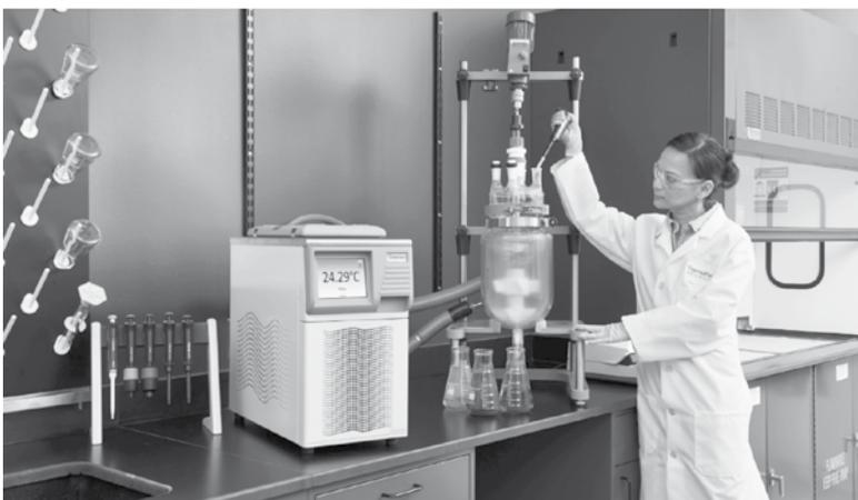
Le couvercle à charnières du VersaCool lui confère des fonctions ergonomiques permettant à l'utilisateur de changer aisément de main pour accéder au bain. Autre fonction ergonomique : la présence du panneau de contrôle sur l'avant de l'instrument. Les utilisateurs n'ont plus à passer au-dessus de la zone du bain pour accéder au système de contrôle, minimisant ainsi le risque de vapeurs interférant avec l'écran tactile.
